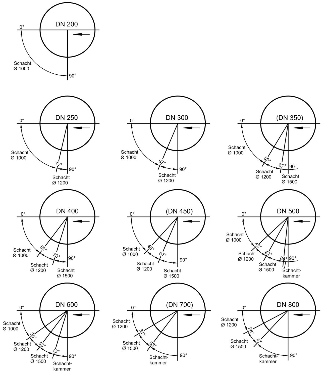
**Bild 5 – Durchmesser von Schachtunterteilen in Abhängigkeit vom Winkel  $\beta$  der Sohlführung ohne Stichmaß a**
