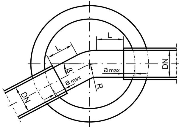
Bild 1 – Beispiel für ein Schachtunterteil mit abgewinkeltem Gerinne (Prinzipskizze)
