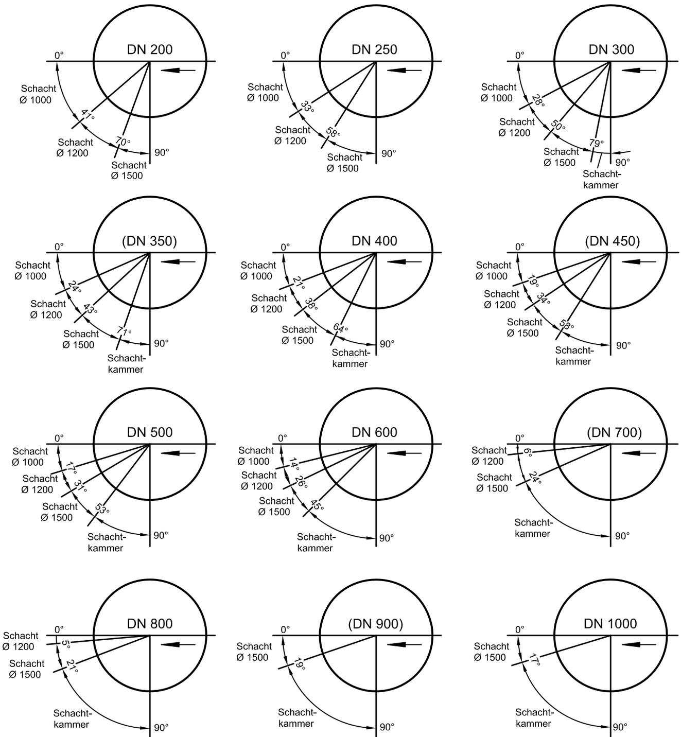
**Bild 2 – Durchmesser von Schachtunterteilen in Abhängigkeit vom Winkel β der Sohlführung und Stichmaß  $a_{max}$**
